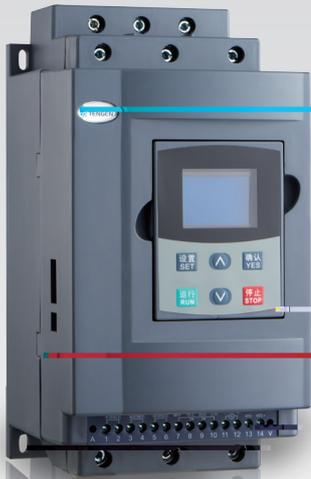
THS1-5000系列软起动器是浙江天正电气股份有限公司最新开发的一款具有国际领先技术的中文智能交流电机软起动器。THS1-5000系列软起动器采用电力电子技术、微处理器技术及现代控制理论技术，具有当今国际先进水平的新型起动设备。该产品能有效地限制异步电动机起动时的起动电流，可广泛应用于风机、水泵、输送类及压缩机等重载设备，是星/三角转换、自耦降压、磁控降压等降压起动设备的理想换代产品。
