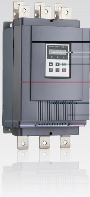
TGS3系列软起动器是以先进的双CPU控制技术为核心，控制可控硅模块，实现（鼠笼式）三相交流异步电动机的软起动、软停止功能，同时具有过载、输入缺相、输出缺相、负载短路、起动限流超时、过电压、欠电压等多项可选保护功能。该产品主要与成套控制柜配套使用，使用中必须配接相应规格的旁路交流接触器。产品规格覆盖11kW~355kW（鼠笼式）三相交流异步电动机，广泛应用于冶金、石油、消防、矿山、石化等工业领域的电气传动设备，是传统的星—三角起动、自耦降压起动最理想的更新换代产品。
